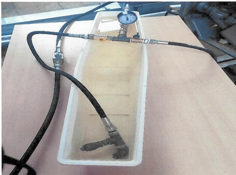
Figura 1. Proba de încercare rezistență la presiune pneumatică a ansamblului fittinguri din fontă pentru instalație de gaze naturale
